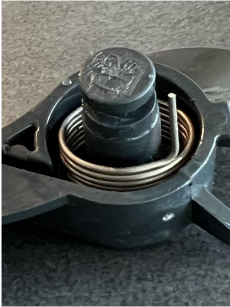
Abbildung 20: Feder mit Piebert Spezialfett versehen und in den Auswurfhebel einlegen
