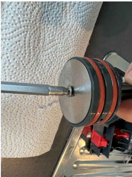
Abbildung 19: Brühsieb auf Brühkolben befestigen mittels Schraube
