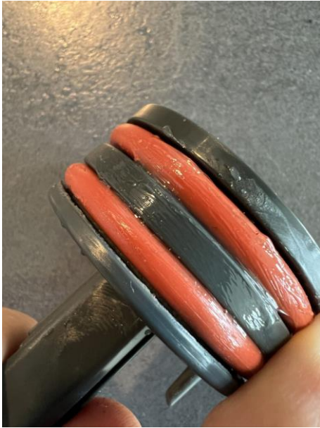
Abbildung 18: Spezialfett um die Mantelfläche des Brühkolbens verteilen mit dem Finger
