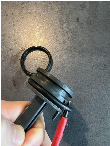
Abbildung 10: O-Ringe mit Schlitzschraubenzieher raushebeln
