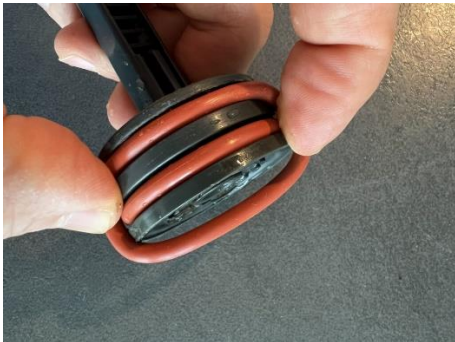
Abbildung 16: Neue Dichtungen aus Pflegeset 200916 aufziehen
