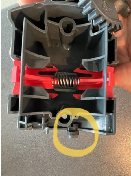
Abbildung 11: Achtung! Gummiteil in Gehäuse versteckt!
