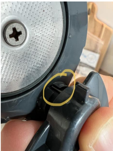
Abbildung 27: Die Feder im Auswurfhebel fädeln wir in das Miniloeh ein.
