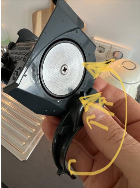
Abbildung 28: Wir drücken den Auswurfhebel nach unten und spannen diesen im Uhrzeigersinn um ca. 90 Grad.
