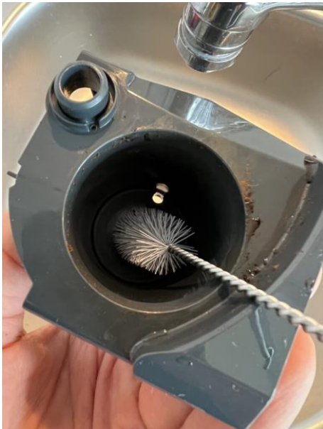
Abbildung 14: Gehäuse reinigen mit Bürste aus dem Pflegeset 200916
