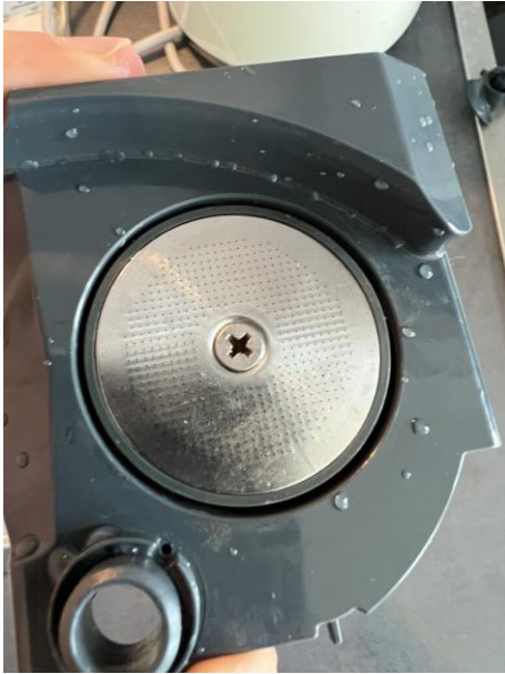
Abbildung 26: Brühsieb muss bündig mit der Oberfläche des Gehäuses abschließen
