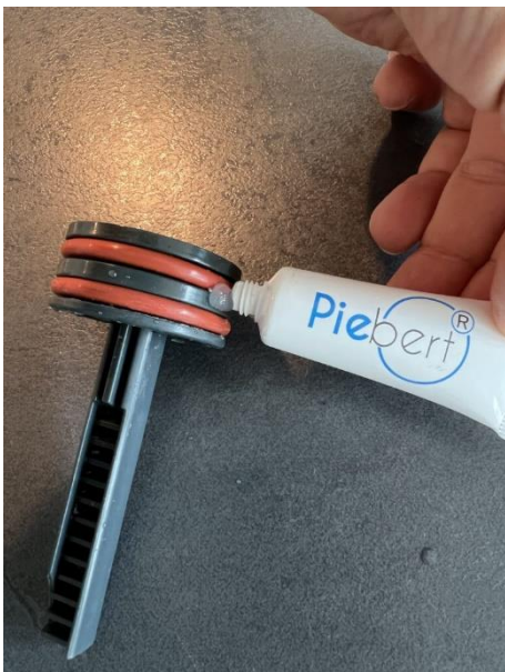
Abbildung 17: Dichtungen mit Piebert Spezialfett ummanteln
