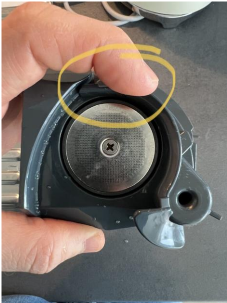
Abbildung 29: Gespannter Auswurfhebel. Wichtig: Im Uhrzeigersinn spannen und festhalten!
